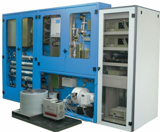
SPALAX, Système de Prélèvement en Ligne avec Analyse du Xénon (CEA/DAM/DIF/DASE, 2004)
